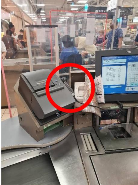
La douchette est positionnée au-dessus de l'imprimante Catalina, face à l'opérateur. Le fil est un fil spiralé, il passe sous l'écran.
